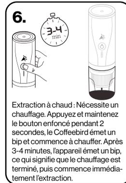
6. Extraction à chaud : Nécessite un chauffage. Appuyez et maintenez le bouton enfoncé pendant 2 secondes, le Coffeebird émet un bip et commence à chauffer. Après 3-4 minutes, l'appareil émet un bip, ce qui signifie que le chauffage est terminé, puis commence immédiatement l'extraction.
