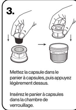
3. Mettez la capsule dans le panier à capsules, puis appuyez légèrement dessus. Insérez le panier à capsules dans la chambre de verrouillage.
