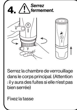
4. **⚠ Serrez fermement.** Serrez la chambre de verrouillage dans le corps principal. (Attention : il y aura des fuites si elle n'est pas bien serrée) Fixez la tasse
