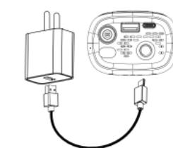
Ingresso di ricarica Type-C 5V/2A. Collegare il cavo di ricarica alla pompa e all'adattatore di alimentazione (da acquistare separatamente) per caricare la pompa. Barra dell'indicatore di alimentazione in stato di carica: barra dell'indicatore lampeggiante: in carica Quando la barra dell'indicatore è completamente accesa: è completamente carica. Suggerimenti: Non utilizzare la pompa durante la ricarica.
