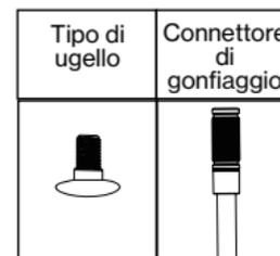
Le mountain bike, le biciclette elettriche, le moto e le auto saranno dotate di valvola Schrader. Gonfiaggio: Collegare la valvola Schrader all'interfaccia della valvola Schrader sul tubo dell'aria ad alta pressione per gonfiare.
